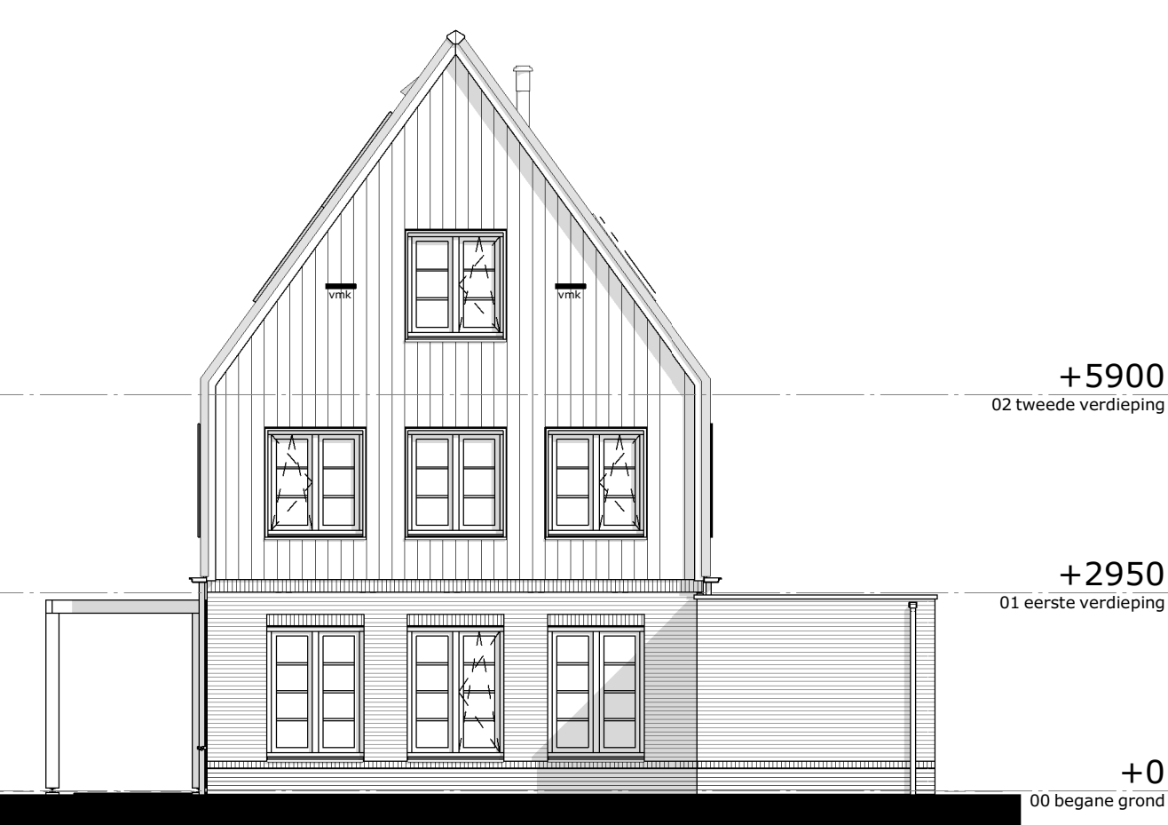
achtergevel vml. - vlieerwaaier in spouw
